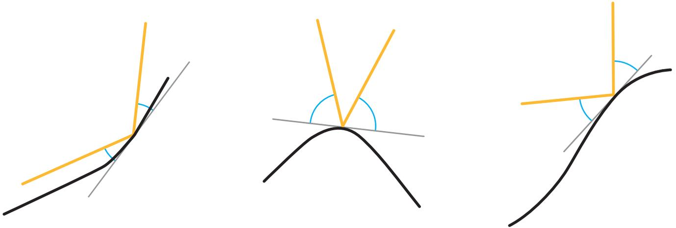
Die Lichtstrahlen sind hier gelb eingezeichnet. Dort, wo der einfallende Lichtstrahl auf den gekrümmten Spiegel trifft, denken wir uns eine Tangente (grau), die den Spiegel genau an diesem Punkt berührt. Einfallswinkel und Ausfallswinkel sind dann die Winkel zwischen der grauen Geraden und dem Lichtstrahl.
